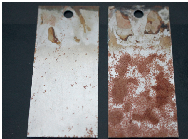
Bild 2. Die Korrosionsspuren auf dem rechten Metallplättchen zeigen das Vorhandensein reaktiver Komponenten im Rezyklat an. Diese können zur Degradierung des Polymers und der Additive führen © Mitsui & Co.
