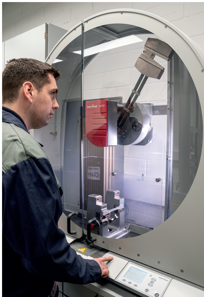
Die Rezyklate werden bei APK unter anderem im Pendelschlagwerk geprüft
